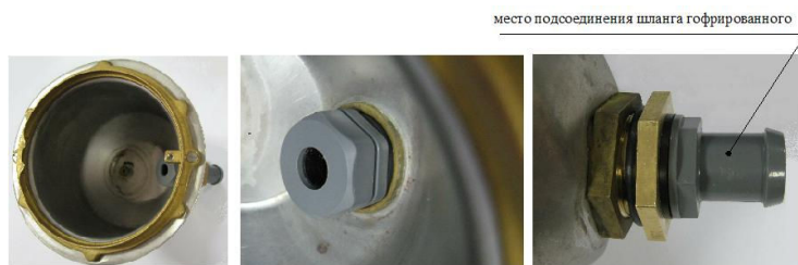
Последовательность сборки сальника
