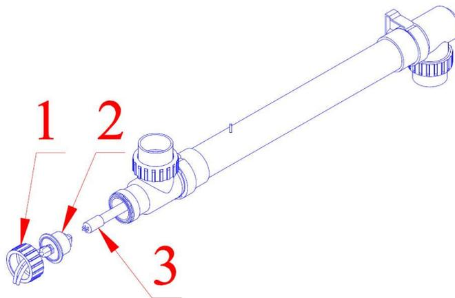
2. Поместите лампу ультрафиолетовую в корпус Установки ультрафиолетовой, как показано на рисунке 6.
