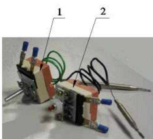
Датчик регулировки температуры (поз.1, рис.4) и датчик перегрева (поз.2, рис.4).
