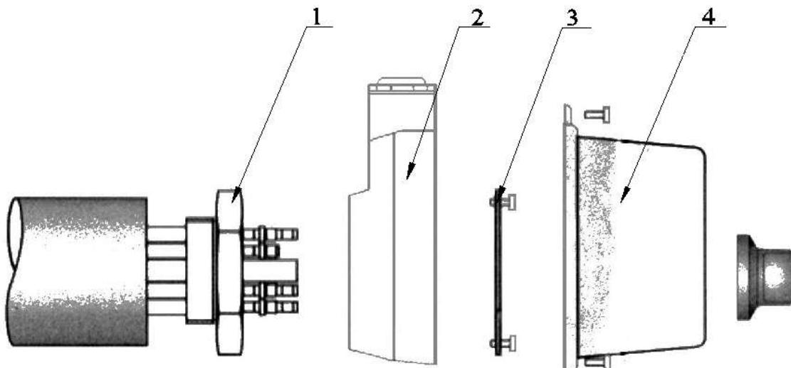
2. При помощи прижимного кольца соедините крышку заднюю с ТЭНами (поз.1, рис.6).
