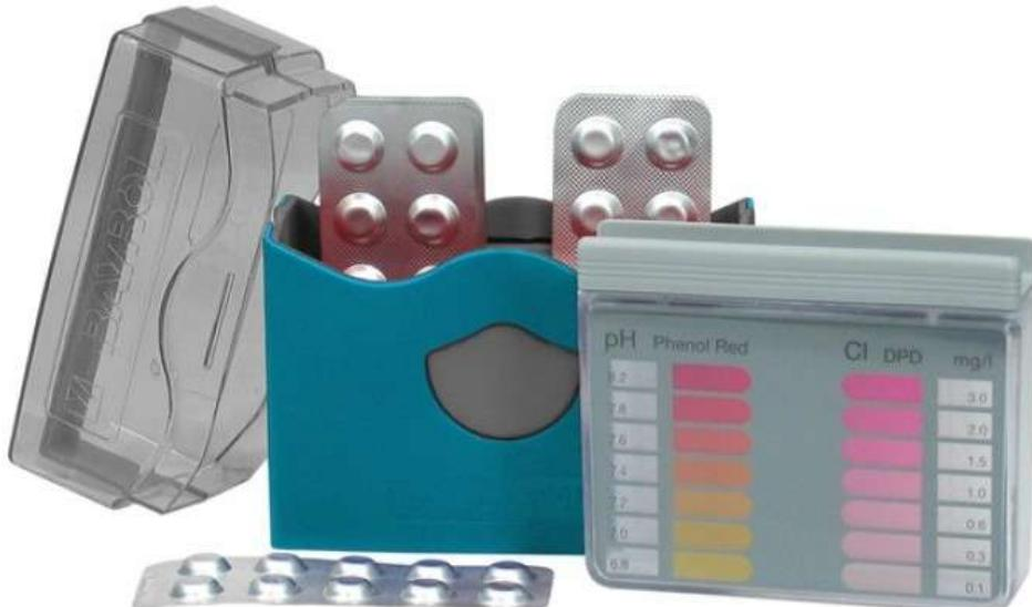
1. Снять верхнюю крышку и промыть поверхности тестера чистой водой.
