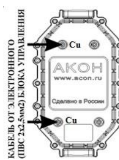
ПОДКЛЮЧЕНИЕ КАБЕЛЯ К ЭЛЕКТРОДУ МЕДИ Cu В SilverPRO LIGHT AUTO SPL 5.2
